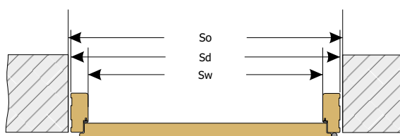
Wymiary ościeżnicy blokowej, system przylgowy
